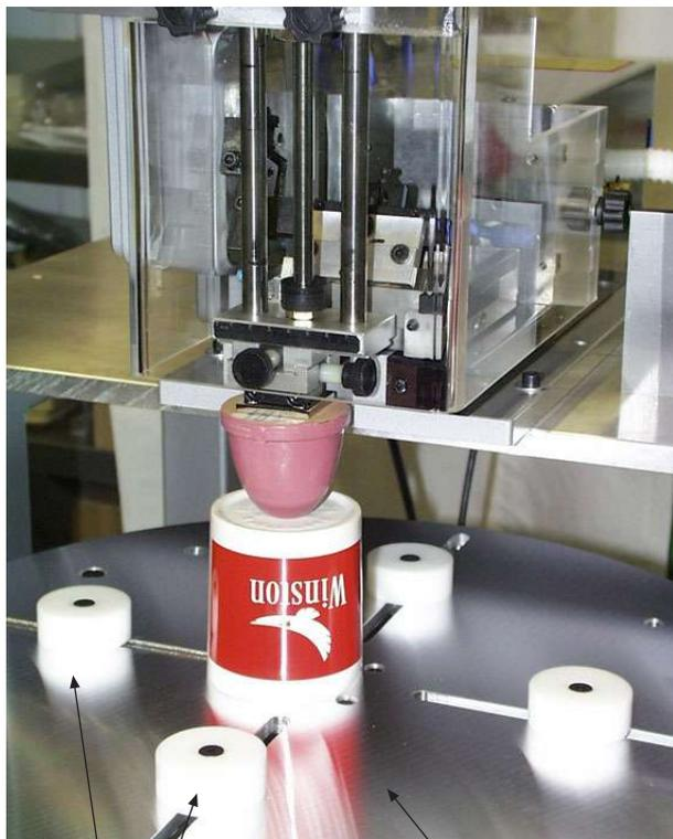
verstellbare Anschläge zur Positionierung
