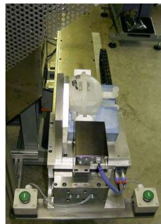
Zweihandauslösung in Be- und Entladeposition
