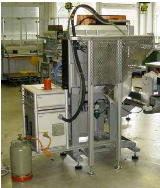
Rückseite der Anlage mit Steuergerät der Beflammung und Schutzumhausung.
