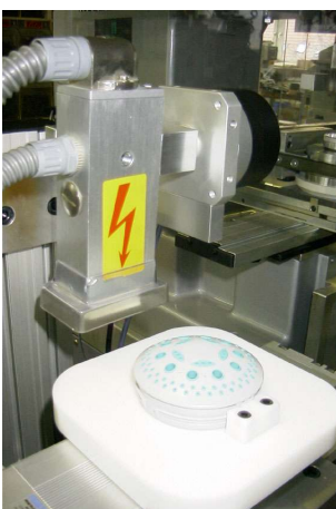
Detailaufnahme der integrierten Coronaeinheit. Hier kann das Druckbild ohne Verfahren des Teils oder des Flammkopfes mit der Flamme abgedeckt werden.
