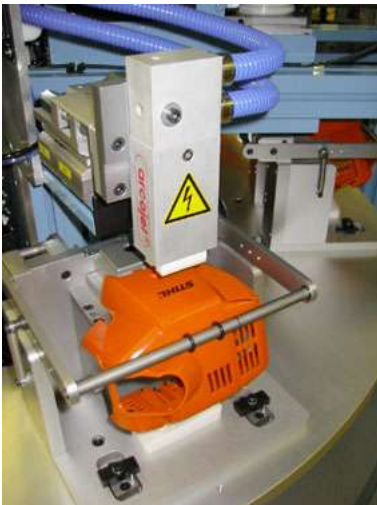
Detailaufnahme der integrierten Coronaeinheit. Hier kann das Druckbild ohne Verfahren des Teils oder des Flammkopfes mit der Flamme abgedeckt werden.
